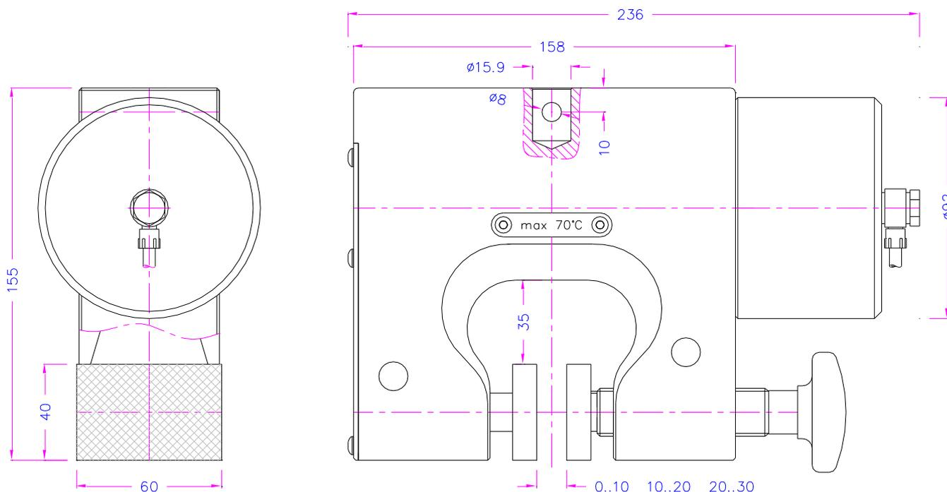
Die Öffnungsweite kann durch Stößel unterschiedlicher Länge eingestellt werden
