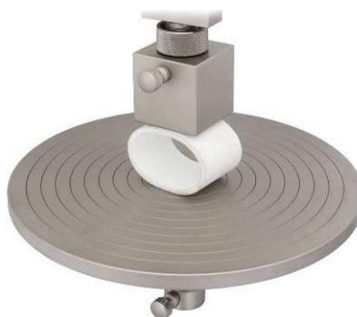
SP23-Q50-R1-Af20-St Druckversuch an Elektroinstallationsrohrsystemen gemäß EN61386-1
